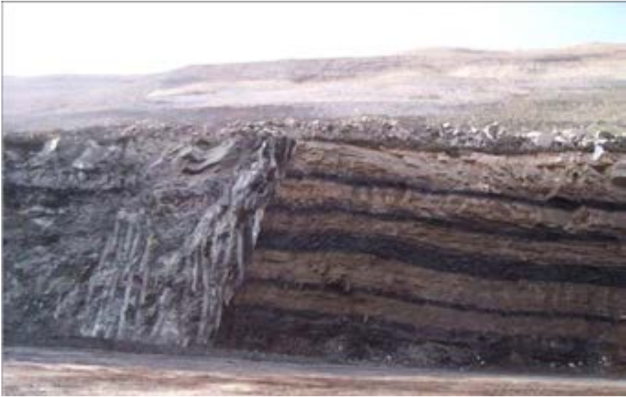
Şekil 3. Soma bölgesinde açık işletme sahasından düşey atımlı bir normal fay görüntüsü. Fayın solunda genç kumtaşı-kiltaşı (p1) ardalanması, sağında ise üst linyit seviyesinin (k3) kömürlü düzeyleri yer alır.
