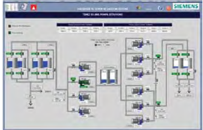
Şekil -4: Temiz Su Pompa İstasyonu
