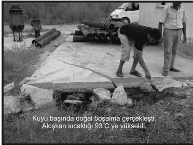
Foto.4. Isı merkezi ana pompanın üretim sırasında sıcaklık ve seviye düşümü olan kuyuda mevsim sonunda yüzeyden 93 0 C akış (Fotoğraflar Karamanderesi vd. 2012'den alınmıştır).
