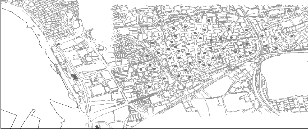
Şekil 4. 2003 Urla Depremi'nde (M=5.6) Bornova/Manavkuyu bölgesinde hasar gören yapıların dağılımı
