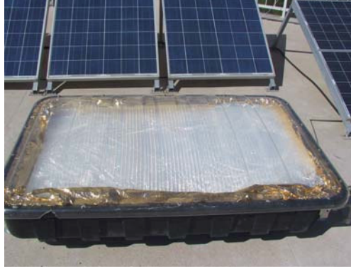
Şekil 4. Güneş Tuzağı, Polimerik Sıcak Su Üretim Sistemi.
