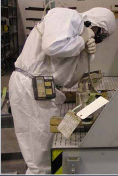
Çalışanın üzerine yerleştirilmiş hava izleme aleti.
