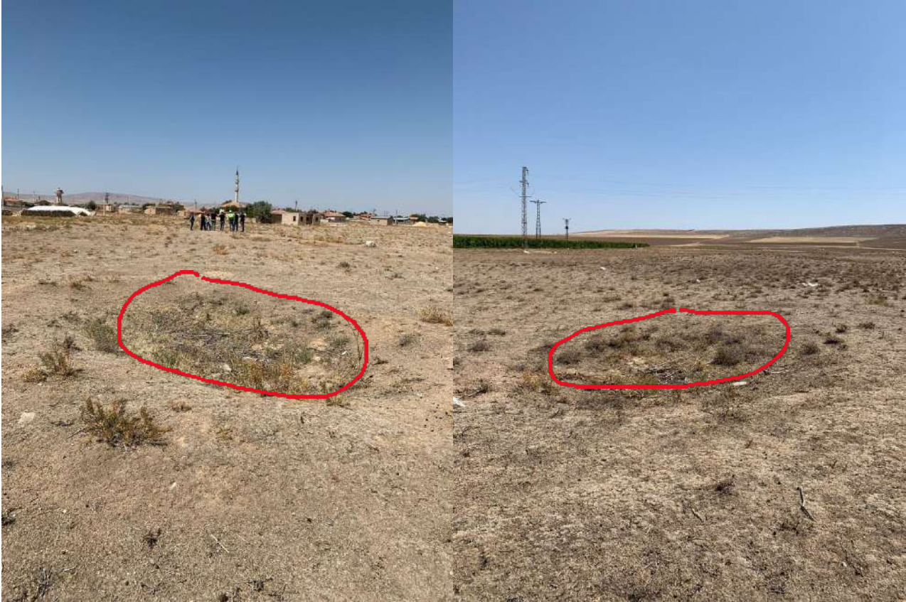
Şekil 13. Kızören Mahallesi'nde gözlenen sığ derinlikli yüzey oturmaları
