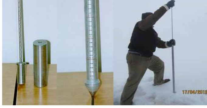
Şekil 6. Ramsonde ile Kar Tabaka Mukavemetinin Belirlenmesi (17.04.12 - Trabzon Karester Yaylası)
