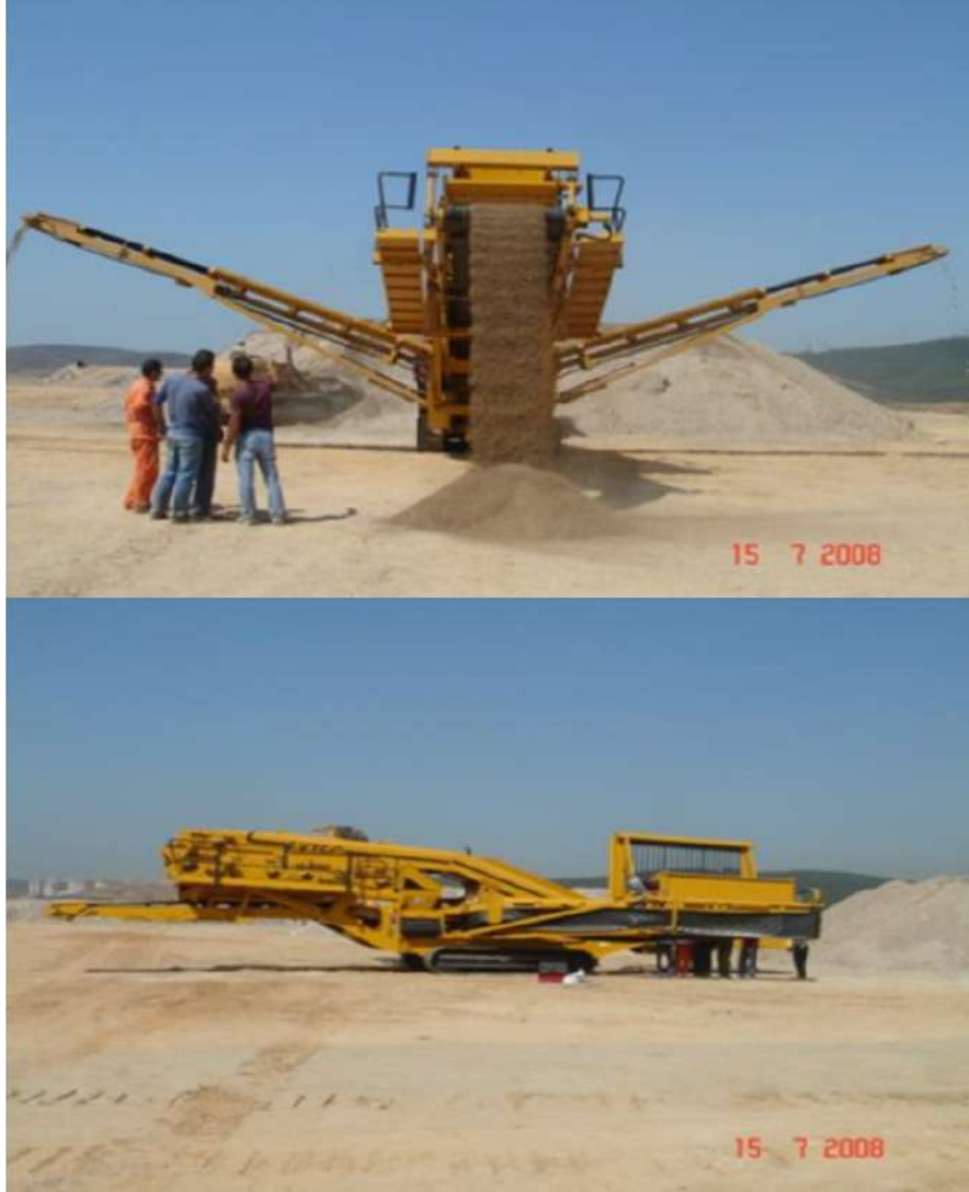
Şekil 11. İ.B.B. Tuzla inşaat ve yıkıntı atıkları geri dönüşüm tesisi
