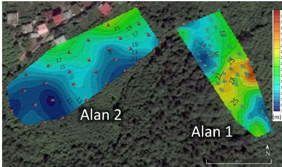
Şekil 8. Alan 1 ve 2 için merkez frekansa göre hesaplanan ana kaya derinlik dağılım haritaları.
